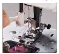
Simplemente baja la palanca, gírala hacia atrás y posiciona el hilo. Esta simple acción logra el fácil enhebrado del hilo en la aguia.
